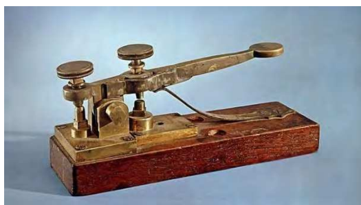
Ilustración 2 Transmisor utilizado por Morse
